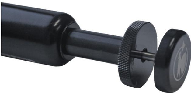
Der M14 Reducer wird auf das Ventil der Gasfeder aufgeschraubt. Durch Druck auf das Griffstück öffnet der Ablassstößel das Ventil und Gas kann entweichen. Der Druck auf das Griffstück darf nicht dauerhaft sein, sondern muss in kurzen Intervallen erfolgen.
