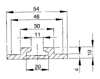
zum einlassen von unten Gewicht: 2.00 Kg / Stange ohne Befestigungsbohrungen
